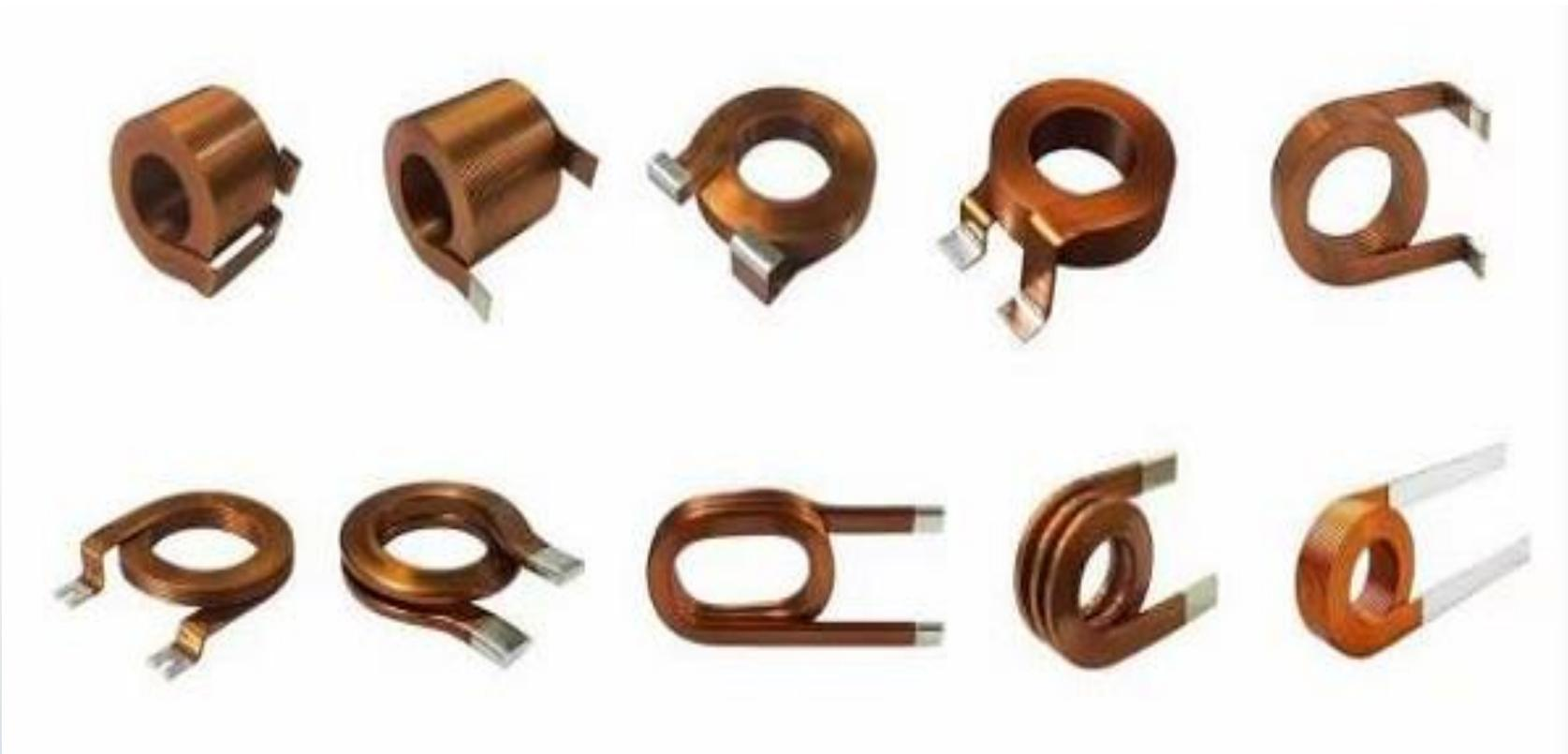
这类线圈，用于设计制造输出滤波电感，差模电感，共模电感。也可用于变压器大电流绕组，具有结构简单，电流密度更低，从而降低损耗。
